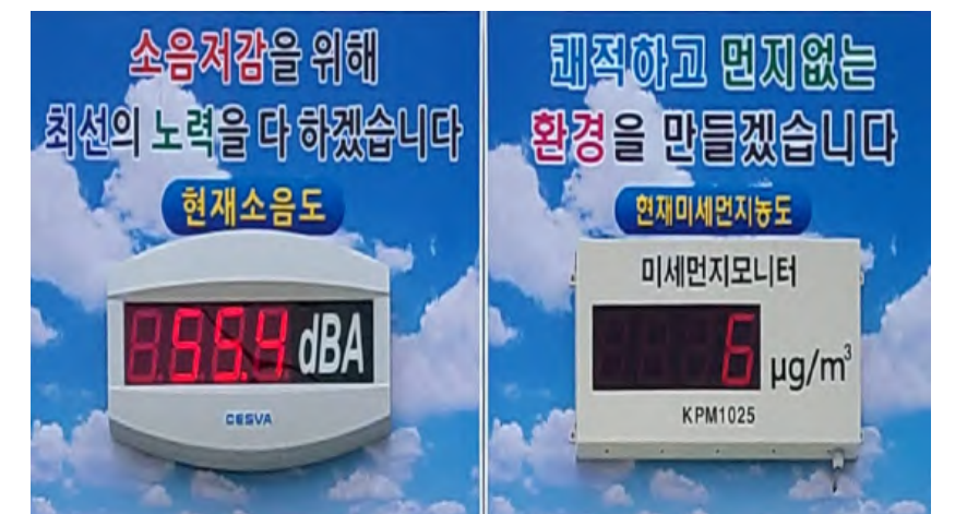
도심지 현장에 설치된 소음 전광판
